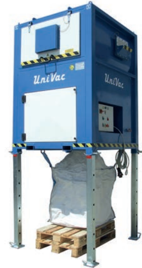
Afb. 4 Stofzuiginstallatie waarbij het opgezogen stof wordt gelost in een bigbag
