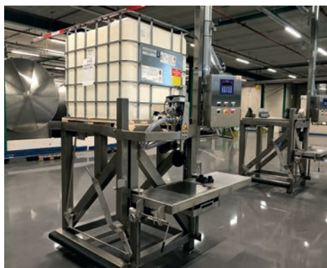
Afb. 8 Een afvulininstallatie met verstelbare tafel, verzonken weegschaal en afzuiging
